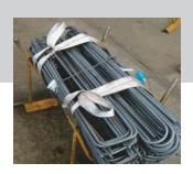
这种吊带仅仅使用在装运过程中。用同一条吊带捆绑钢管,可以在整个工厂搬运
